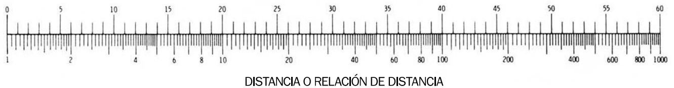
Figura A7.10 Nomogramas para determinar las relaciones de potencia, tensión, y niveles de presión sonora (SPL) (Véase el Apéndice 1, figuras A1.8, A1.9, y A1.10)
